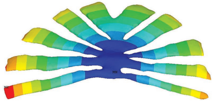
骨をたわませるのに必要な荷重と、たわんだ前頭骨の変形を示した構造解析結果
